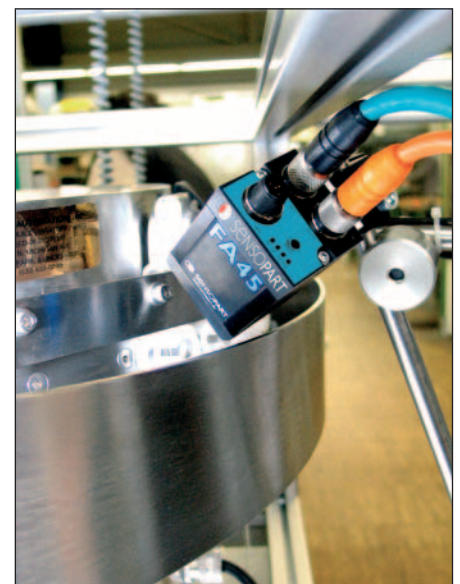
Abb. 1: Industrielle Bildverarbeitung für kleine Budgets: Lagekontrolle von Kunststoffklammern mit dem Vision-Sensor FA45.
