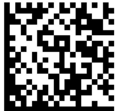
Abb. 4b: Aufbau DataMatrix-Code: Im abgebildeten Beispiel ist das Wort „SensoPart Reader“ codiert.
