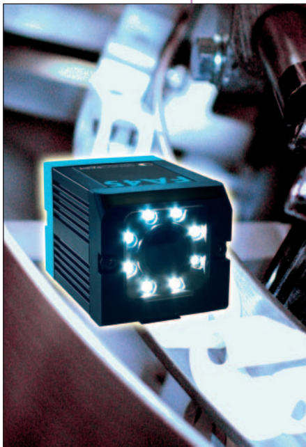
Abb. 3: Alles dran, alles drin: Im Gegensatz zu klassischen BV-Systemen kommt der FA45 in den meisten Anwendungsfällen ohne externe Komponenten aus. In dem nur 65 x 45 x 45 mm 3 kleinen Aluminiumstrangguss-Gehäuse steckt die Rechenleistung eines Pentium-Prozessors.
